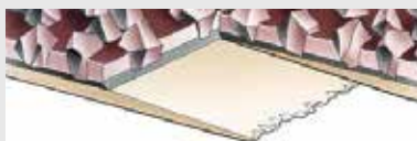
Überlappende Verbindung ohne Kornabschliff
