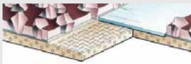
Gestossene Verbindung mit kornseitiger Spezialfolie
